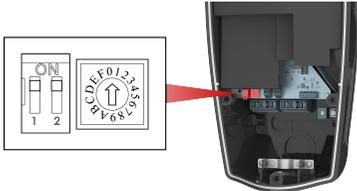
**⚠** **Warnung:** Vor allen Einstellungen und Änderungen an den DIP-Schaltern und dem Drehschalter MUSS der Strom abgestellt werden. Beim Verstellen dieser Schalter bei eingeschaltetem Strom werden die Änderungen vom System nicht erkannt. Es besteht Stromschlaggefahr!
