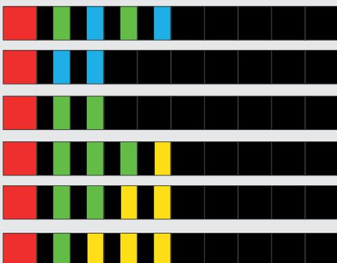
Wenn die LED einmal rot und im Anschluss blau, grün oder gelb blinkt, hat die Wallbox einen Fehler erkannt. Die Wallbox startet den Ladevorgang automatisch neu, um den Fehler zurückzusetzen.
