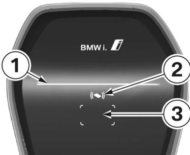
Der RFID-Sensor dient zur berührungslosen Autorisierung eines Benutzers zum Laden an der Wallbox mit **RFID-Karten** nach ISO14443 und ISO15693.
